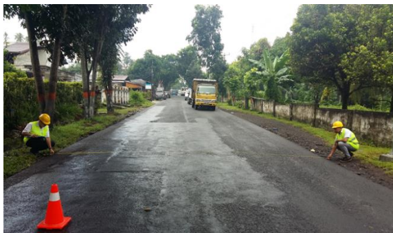
Gambar. Dokumentasi Potongan Melintang Pos Survai di Pendekat Manado Ruas Jalan Manado - Bitung.
