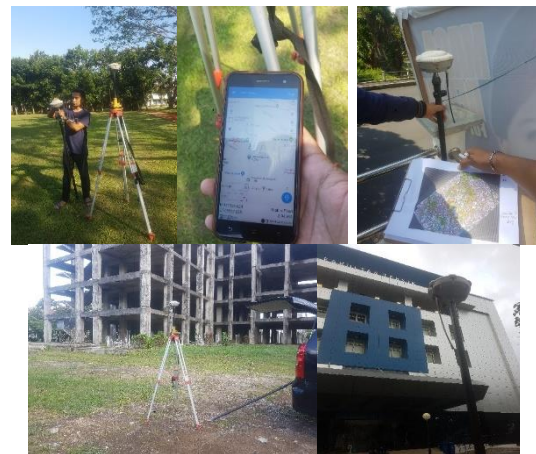
Gambar 8. Persiapan Pengukuran Titik Kontrol Tanah ( GCP ).
