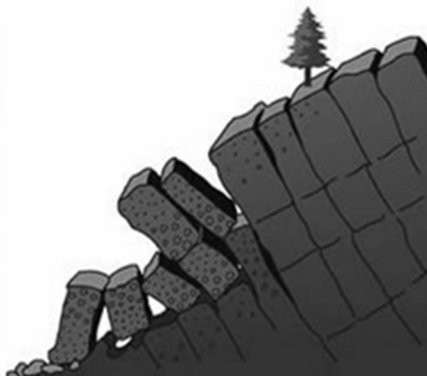
Gambar 2. Jenis Longsoran Robohan ( Topples )
