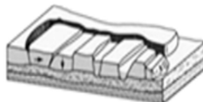
Gambar 5. Jenis Longsoran Pencaran lateral ( lateral spread )
