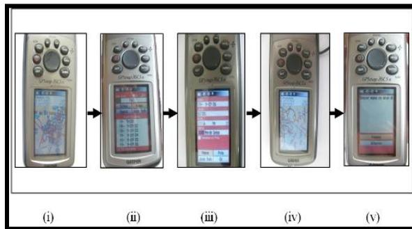
Gambar 3. Kalibrasi Alat GPS dan Pengosongan Memori
