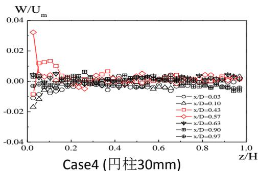
Gambar 5. Distribusi kecepatan sekunder arah vertikal komponen W
