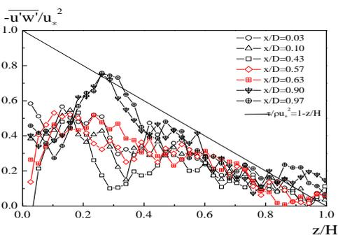
Gambar 6. Tegangan geser Reynold arah vertikal
