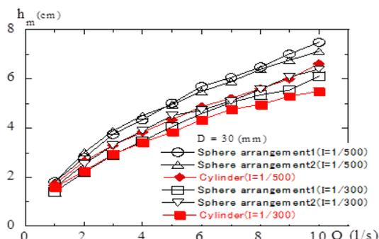
Gambar 2. Hubungan antara debit air dan kedalaman aliran seragam
