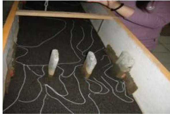
Gambar 4. Kontur Abutmen untuk  $Q_2$  Berdasarkan Skala Model
