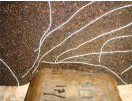
Gambar 6. Kontur Abutmen Pemanding Untuk  $Q_2$  ( $0,7032 \text{ m}^3/\text{det}$ )
