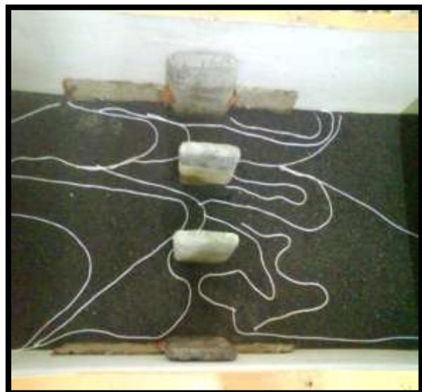
Gambar 2. Kontur Abutmen Berdasarkan Skala Model untuk  $Q_1$  (1,434 ltr/det)
