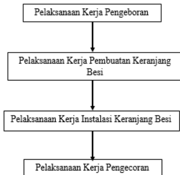
Gambar 1. Langkah-langkah Pelaksanaan Pondasi Bored Pile
