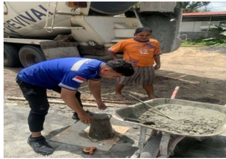
Gambar 7. Pengisian Beton ke Kerucut Abram
