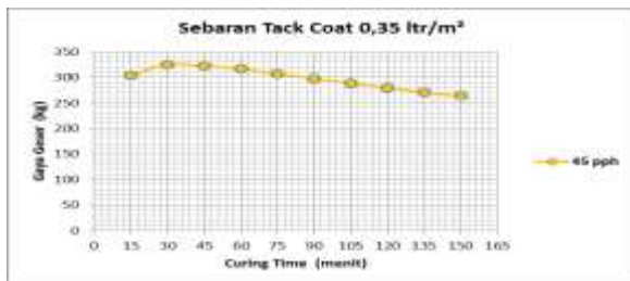
Gambar 22. Hubungan curing time dengan kuat geser variasi aspal 45 pph dengan takaran sebaran tack coat 0,35 ltr/m 2 perkerasan lentur
