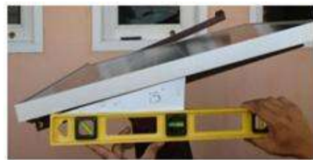
Gambar 1. Posisi PV kemiringan 15^{\circ} (dok.peneliti)
