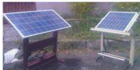
Gambar 2. Posisi PV 50 Wp menghadap Barat 45^{\circ} dan PV 100 Wp menghadap Selatan dengan sudut kemiringan 45^{\circ} (Dokumentasi peneliti)
