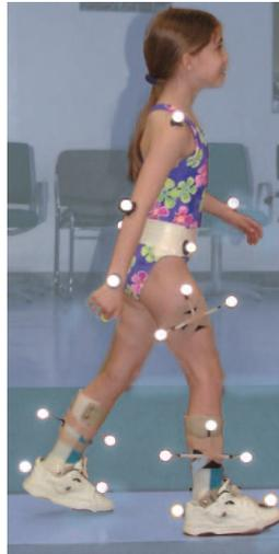
Gambar 66. Sistem pengukuran gait yang paling sering yaitu dengan menggunakan penanda retroreflektif berupa beberapa kamera video. Penanda menentukan titik anatomikal tubuh tertentu yang digunakan oleh program komputer untuk menghitung gerakan sendi.<sup>1</sup>
