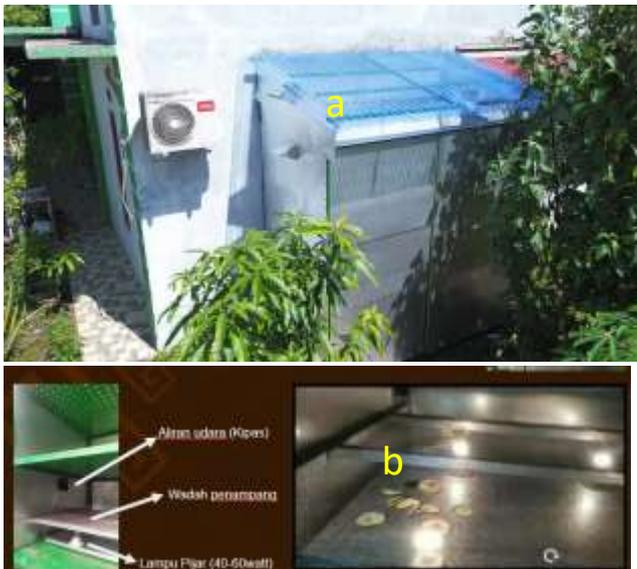
Gambar 6. Penampakan pengering CV Biovina setelah PKM dan dilakukan perbaikan bagian luar (a) dan bagian dalamnya (b) diperbaiki aliran udara dan sanitasinya dengan tertutup dipasangkan listrik untuk pemanasan jika musim penghujan.
