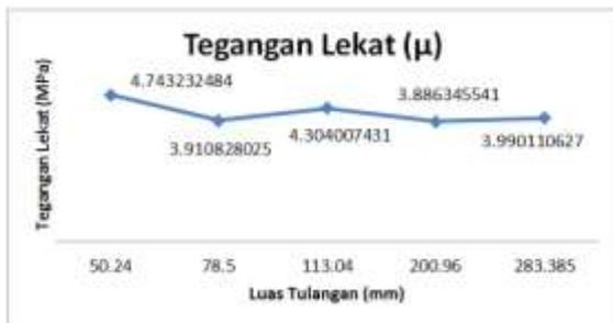
Gambar 3. Diagram Tegangan Tarik Pencabutan Keluar (*Pull-out*) Rata-Rata
