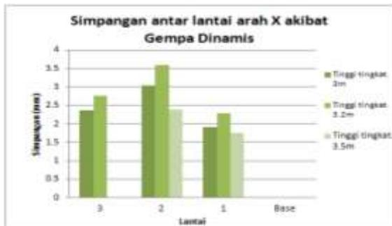
Gambar 9. Grafik perbandingan simpangan max antar lantai semua tinggi antar tingkat arah X
