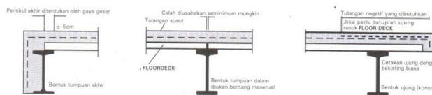
Gambar 11. Penampang Melintang Balok Baja yang terpasang Dek Baja Gelombang
