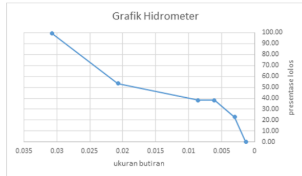
Gambar 2. Kurva distribusi ukuran butiran
