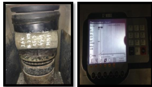
Gambar 12. Contoh Sampel Pemeriksaan Kuat Tarik Belah Beton (Sumber: Dokumentasi Peneliti)
