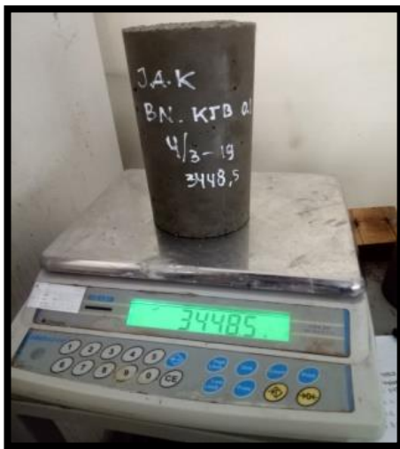
Gambar 7. Contoh Sampel yang di Timbang untuk Pemeriksaan Berat Volume (Sumber: Dokumentasi Peneliti)
