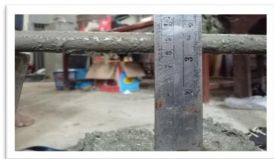
Gambar 6. Contoh Sampel Pengukuran Nilai Slump (Sumber : Dokumentasi Peneliti)
