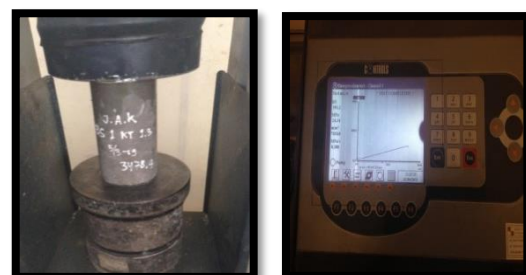
Gambar 8. Contoh Sampel Pemeriksaan Kuat Tekan Beton (Sumber : Dokumentasi Peneliti)
