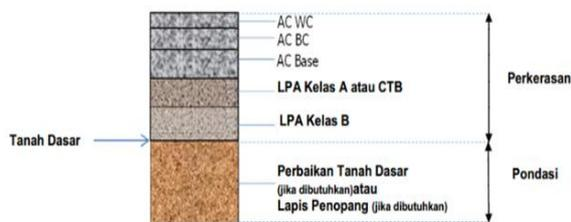
Gambar 5. Perkerasan lentur pada permukaan tanah asli.
