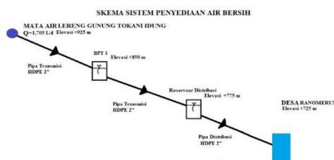
Gambar 2. Skema Sistem Penyediaan Air Bersih
