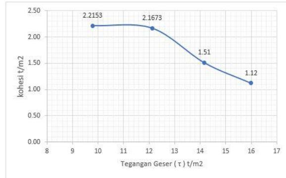
Gambar 6. Hubungan Kohesi dengan Tegangan Geser
