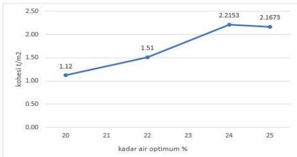
Gambar 4. Hubungan Kohesi dengan Kadar Air Optimum
