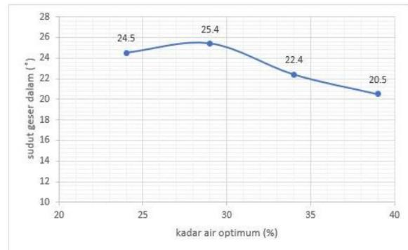
Gambar 7. Hubungan Sudut Geser Dalam dengan Kadar Air Optimum
