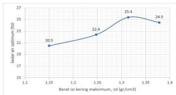
Gambar 5. Hubungan Kadar Air Optimum dengan Berat Isi Kering
