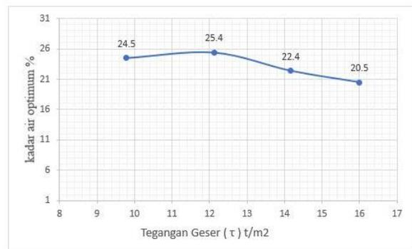
Gambar 8. Hubungan Kadar Air Optimum dengan Tegangan Geser
