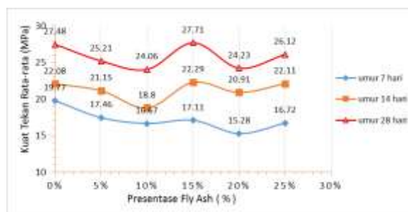
Gambar 1. Hubungan antara Kuat Tekan mortar rata-rata terhadap persentase abu terbang ( fly ash ).
