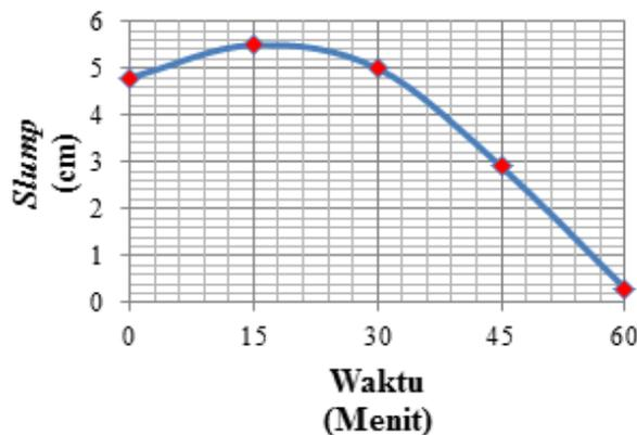
Gambar 2. Hubungan Slump Terhadap Waktu (Tanpa Superplasticizer)
