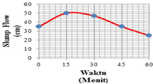
Gambar 9. Hubungan *Slump Flow* Terhadap Waktu (*Superplasticizer* 1%)
