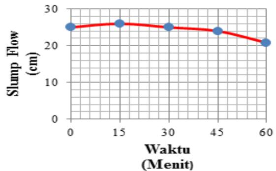
Gambar 3. Hubungan Slump Flow Terhadap Waktu (Tanpa Superplasticizer)
