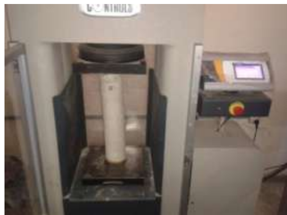
Gambar 2. Kolom bulat yang ditempatkan pada alat uji
