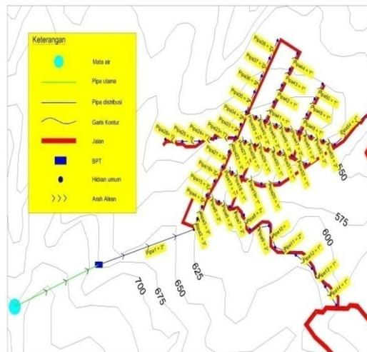
**Gambar 6 Ukuran Pipa distribusi dihitung dengan program EPANET 2.0**
