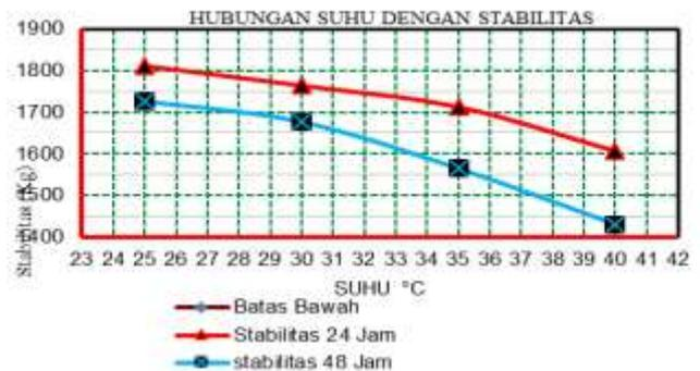
Gambar 4. Hubungan Variasi Suhu dengan Stabilitas Air Tawar
