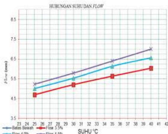
Gambar 8. Hubungan Variasi Suhu, Variasi Kadar Garam dengan Flow Dalam Perendaman Air Laut Selama 24 Jam
