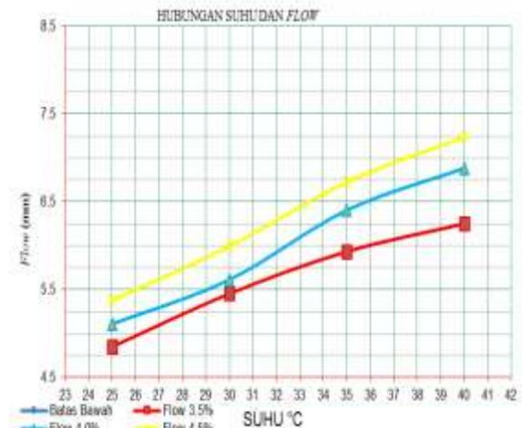
Gambar 11. Hubungan Variasi Suhu, Variasi Kadar Garam dengan Flow Dalam Perendaman Air Laut Selama 48 Jam
