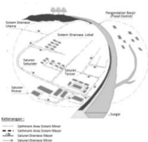
Gambar 1. Lay-Out Umum dari Sistem Drainase Perkotaan
