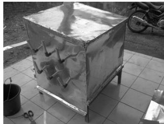
Gambar 4. Kondisi Alat Pengering Tertutup
