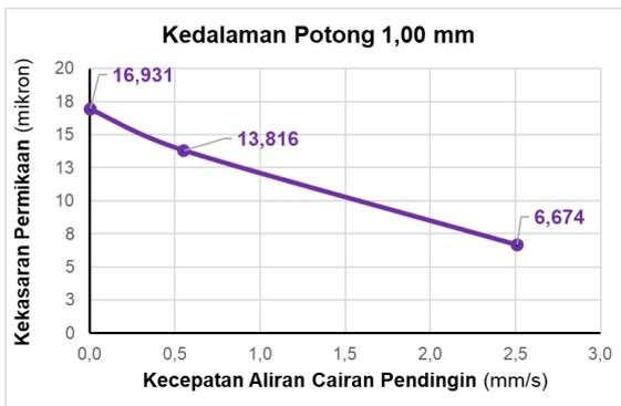
Gambar 4.2 kecepatan cairan pendingin terhadap kekasaran permukaan untuk kedalaman potong 1,00 mm
