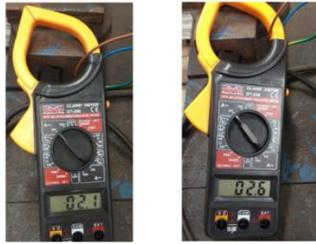
Gambar 3.5 Pengukuran arus motor listrik
