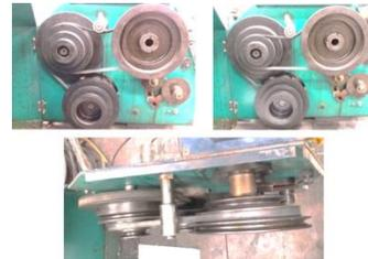
Gambar 3.4 Pengaturan putaran pada mesin bubut BV 20
