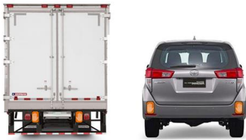
Gambar 6. Contoh posisi pemasangan lampu peringatan tidak menyalip
