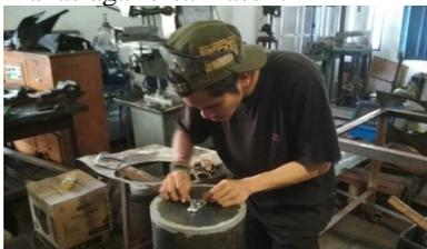
Gambar 12. Pemasangan baut pengunci pada elemen pemanas
