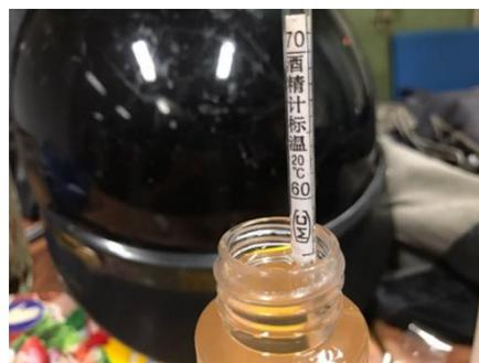
Gambar 19. Pengukuran kadar alkohol 55%
