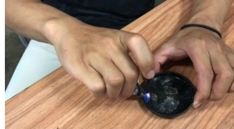
Gambar 3.19 Uji coba pembakaran hasil Plastik PET
