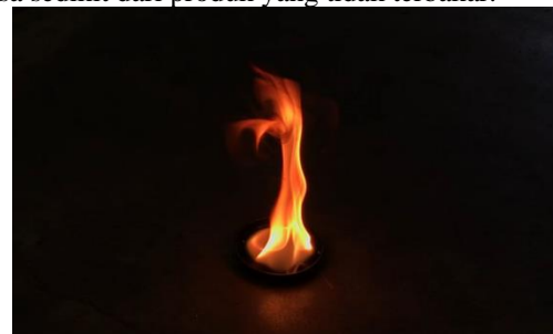
Gambar 3.20 Uji coba pembakaran hasil Plastik PP
