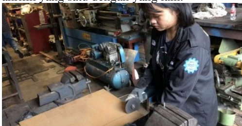
Gambar 3.11 Pembuatan panel kontrol
