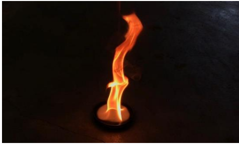
Gambar 3.22 Uji coba pembakaran hasil Plastik LDPE
