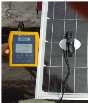
Gambar 3.9: Pengukuran Kemiringan Panel Surya dan Intensitas Cahaya Matahari.
