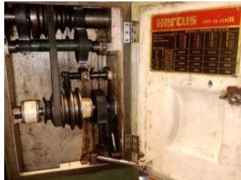
Gambar 4.2 Kondisi Putaran Mesin Freis HERCUS CF 7264
