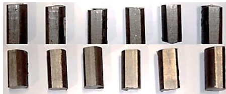
Gambar 4.4 Hasil Proses Freis pada Benda Uji
