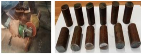
Gambar 4.1 Pematangan Benda Uji
