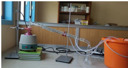
Gambar 3. Proses isolasi minyak atsiri bunga mawar dengan metode destilasi air
