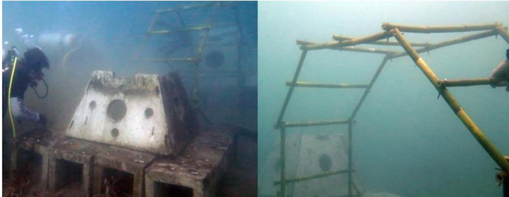
Gambar 05. Substrat Beton (a) dan Bambu (b)
