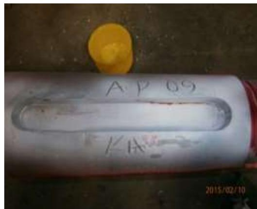
Gambar 4.2 Poros propeller kapal Anugrah Perdana-09 sisi kiri
