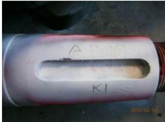
Gambar 4.1 Poros propeller kapal Anugrah Perdana 09 yang retak
