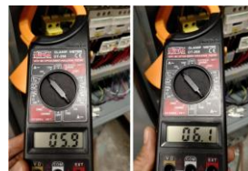
Gambar 3.10 Pengukuran arus motor listrik
