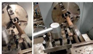
Gambar 3.7 Pengukuran batas panjang pemotongan
