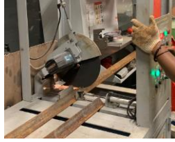
Gambar 3.2 Pemotongan besi siku
