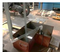
Gambar 3.6 Perakitan sistem pendingin pada mesin bubut BV 20
