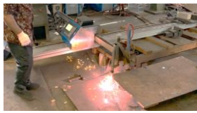
Gambar 3.3 Pemotongan besi pelat
