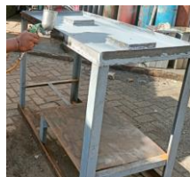
Gambar 3.5 Pengecatan rangka sistem pendingin
