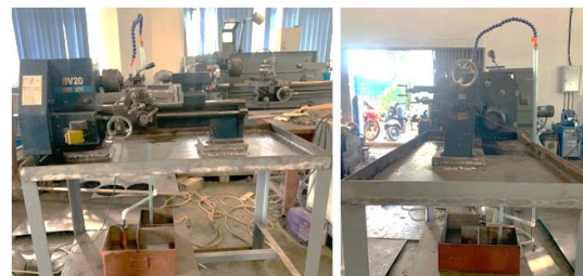
Gambar 4.3 Hasil rancang bangun sistem pendingin untuk mesin bubut BV 20
