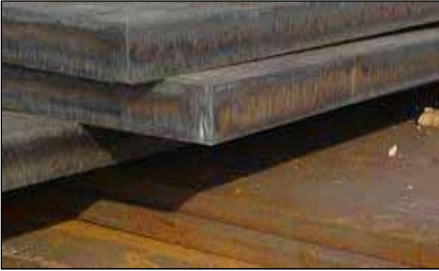
Gambar 2.2 Besi Plat ASTM 36 (Steel Adi Surva 2022)
