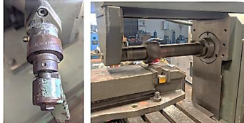
Gambar 3.6 Pengaturan Kedalaman Potong dan Proses Freis
