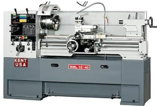
Gambar 2.1 Mesin bubut KENT USA RML-1640T yang ada di Laboratorium Teknik Mesin Unsrat
