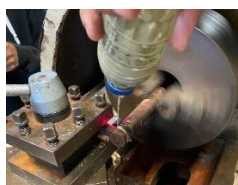
Gambar 3.10 Pembubutan benda uji
