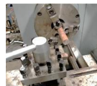
Gambar 3.7 Pemasangan benda uji
