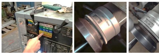
Gambar 3.9 Pengaturan putara gerak makan dan kedalaman potong
