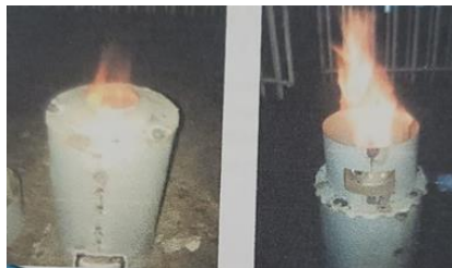
Gambar 5. Api yang dihasilkan saat menjadi gas, gambar bagian kanan, yang menggunakan blower (penghembus udara).
