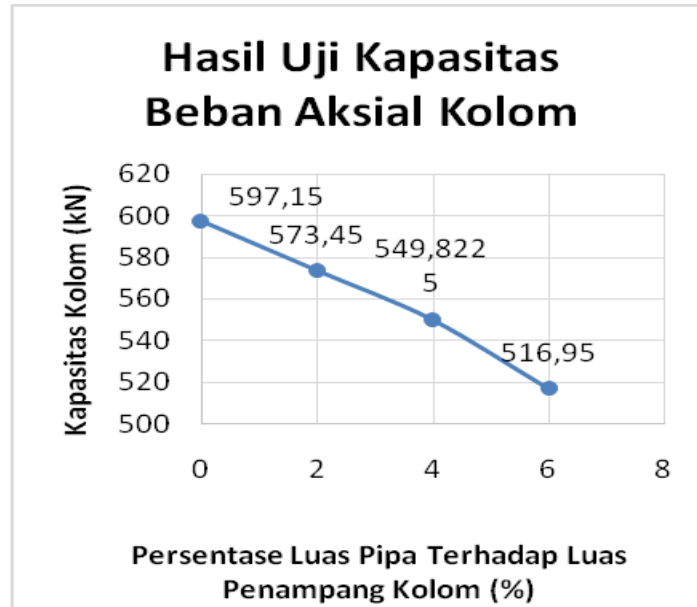
Gambar 2. Grafik Hasil Pengujian Kapasitas Beban Aksial Kolom Segi Empat 150 x 150 x 100 mm
