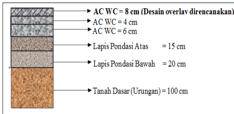
Gambar 5. Struktur lapis Perkerasan setelah dioverlay
