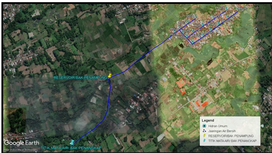
Gambar 5. Plan Skema Sistem Jaringan Air Bersih
