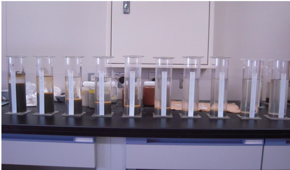
**Gambar 1.** Test Silinder untuk Uji Sedimentasi
