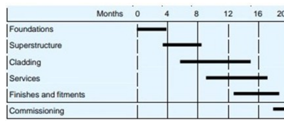
Gambar 2. Jadwal Konstruksi Bangunan Baja Tipikal 4-6 Tingkat.
