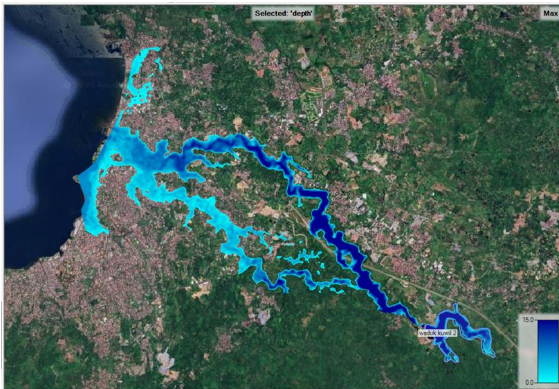
Gambar 5. Hasil Luasan Banjir Simulasi Keruntuhan Bendungan Kuwil Kawangkoan akibat Piping pada HEC-RAS
