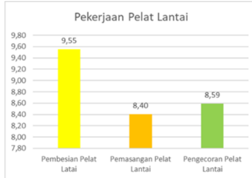
Gambar 4. Tingkat Risiko Pengendalian Mutu pada Pekerjaan Pelat Lantai
