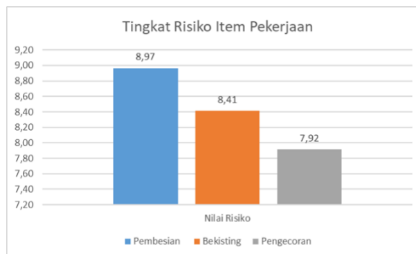
Gambar 5. Tingkat Risiko Pekerjaan Pembesian, Bekisting, dan Pengecoran
